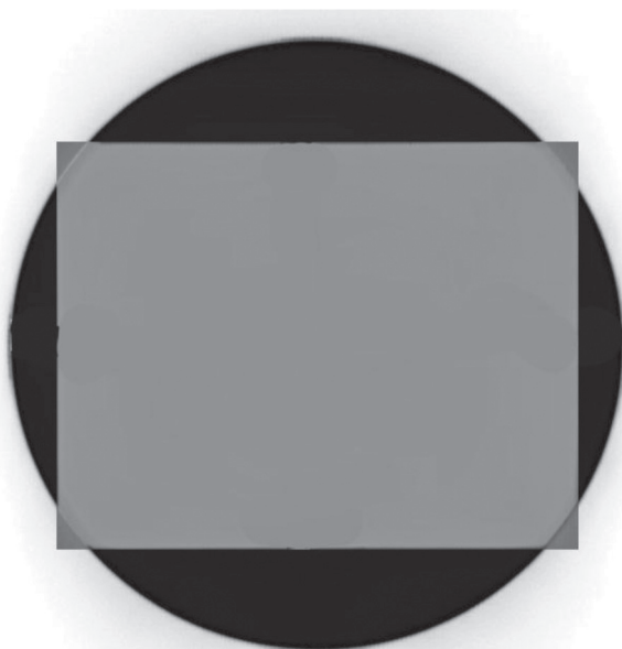
Slika 3: Prekrivanje rentgenskih slik okrogle in pravokotne zaslonke
